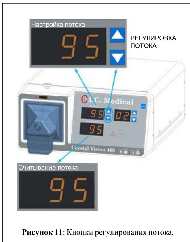
**Рисунок 11:** Кнопки регулирования потока.
