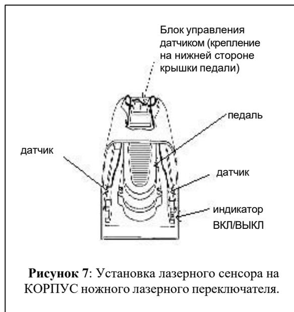
Рисунок 7: Установка лазерного сенсора на КОРПУС ножного лазерного переключателя.
