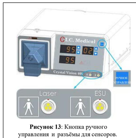
Рисунок 13: Кнопка ручного управления и разъемы для сенсоров.
