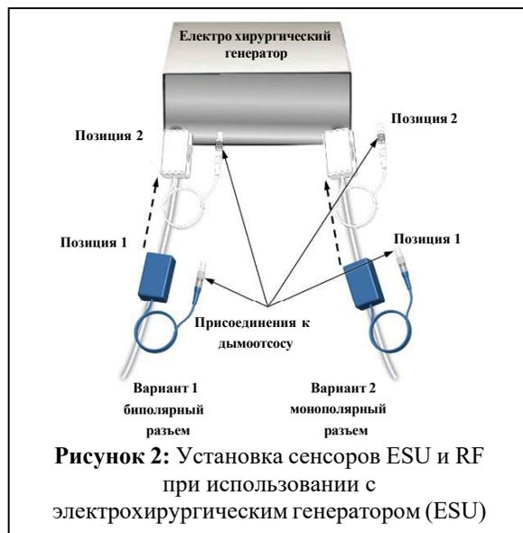
Рисунок 2: Установка сенсоров ESU и RF при использовании с электрохирургическим генератором (ESU)
