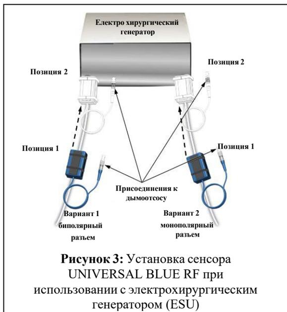
Рисунок 3: Установка сенсора UNIVERSAL BLUE RF при использовании с электрохирургическим генератором (ESU)
